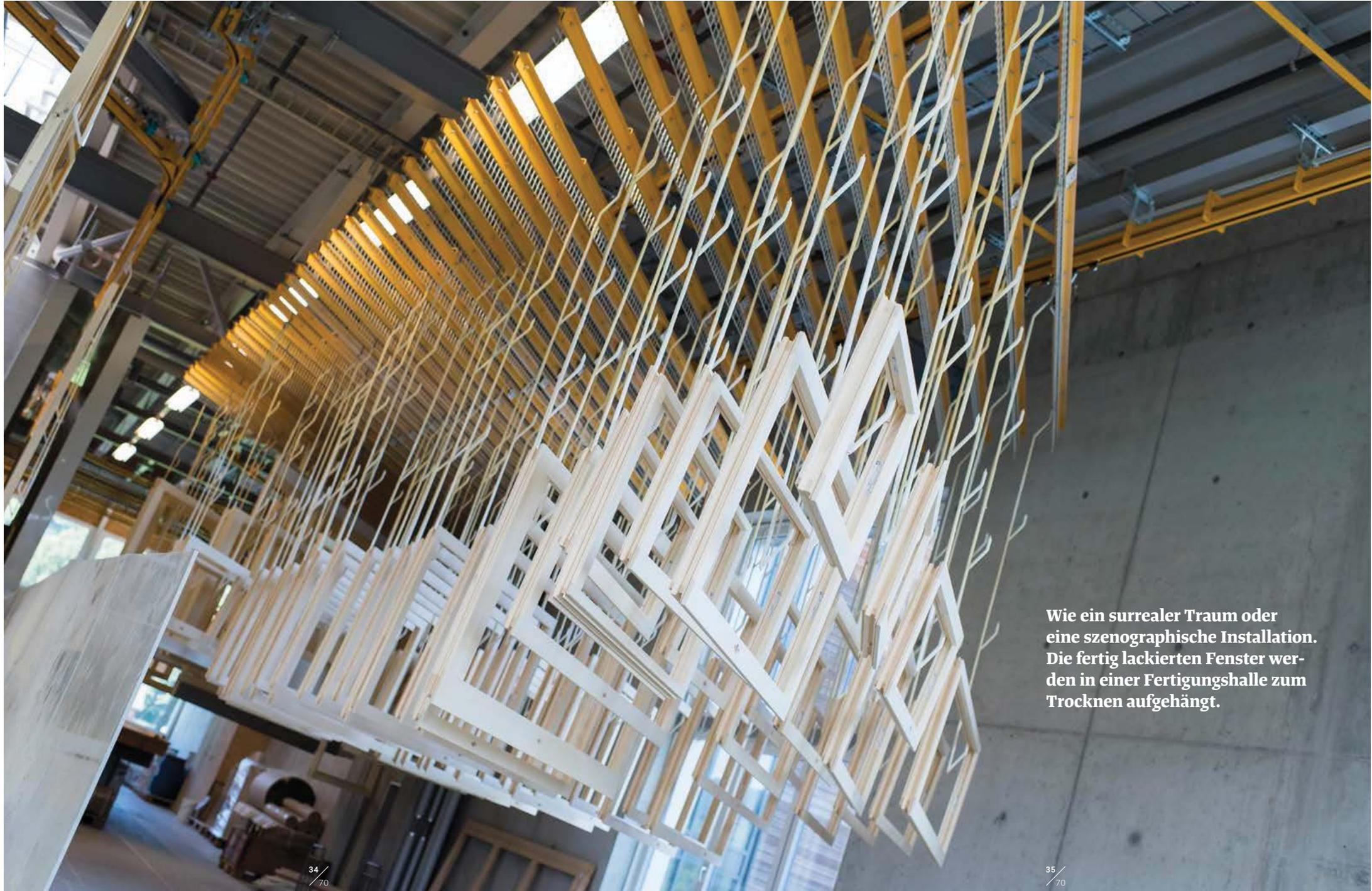
**Wie ein surrealer Traum oder eine szenographische Installation. Die fertig lackierten Fenster werden in einer Fertigungshalle zum Trocknen aufgehängt.**
