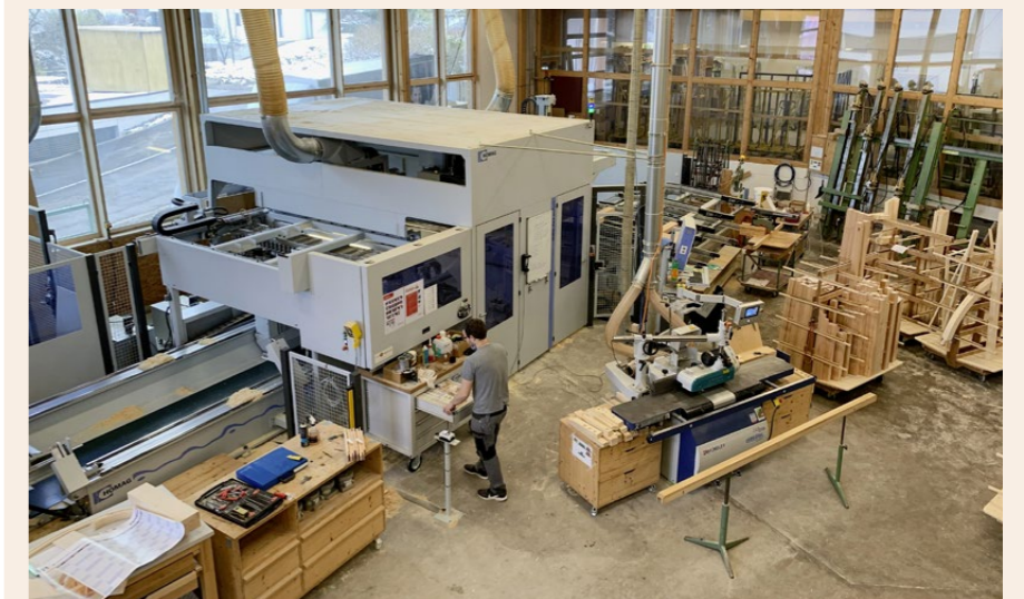
Die Herstellung der neuen Sicherheitsfenster für die Stiftsbibliothek im Werk Hinterforst, welches auf die Produktion und Restaurierung von denkmalpflegerelevanten Fenstern spezialisiert ist.
